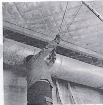
有组织废气采样照片
